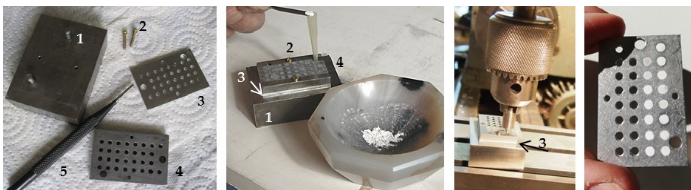
Seqüència de la preparació de mostres per a l'anàlisi CL-quantitatiu, desenvolupada per Ph. Blanc a la UPMC de París (© Ph. Blanc)
