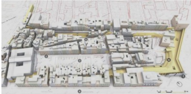
Circo romano de Tarragona. Muestra modelo mapa de puntos obtenidos a partir del escáner láser. Imagen: ICAC.
